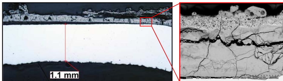
Bild 18: Querschliff im abgezehrten Bereich eines durch H_2S -Angriff abgezehrtes Rohres
