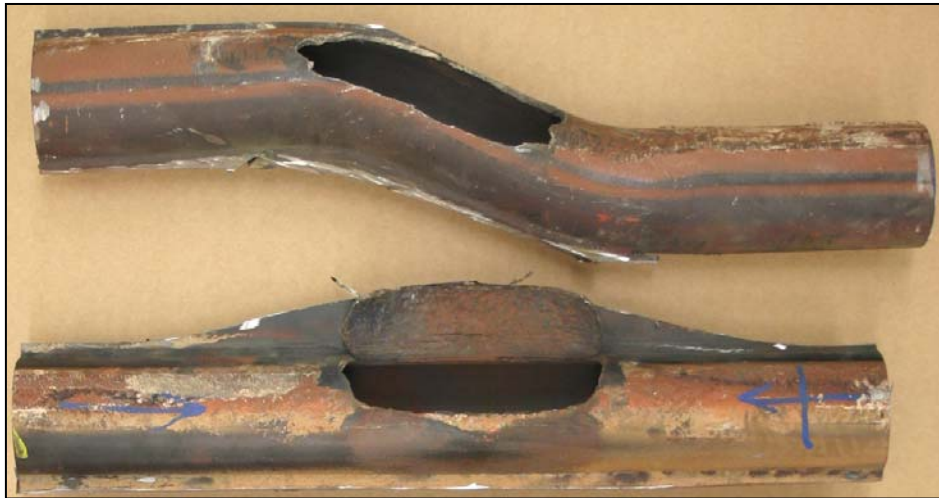
Bild 9: Charakteristische Wandausbrüche an Verdampferrohren und muldenartiger Korrosionsangriff auf der Rohrinneoberfläche
