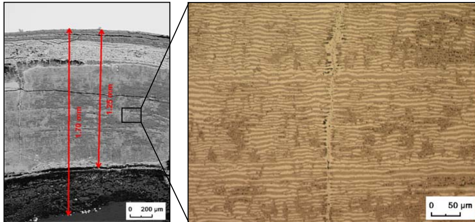
Bild 11: Ausgeprägte „Lamellierung“ (Doppelschichtstruktur) der Magnetitbeläge
