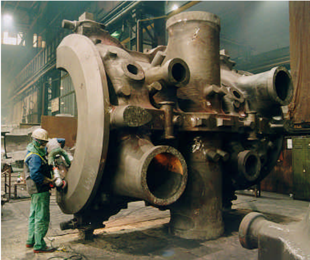
Abbildung 11: Projekt Boxberg, MD Innengehäuse 60 t (G-X 12 CrMoWVNbN 10 1 1)
