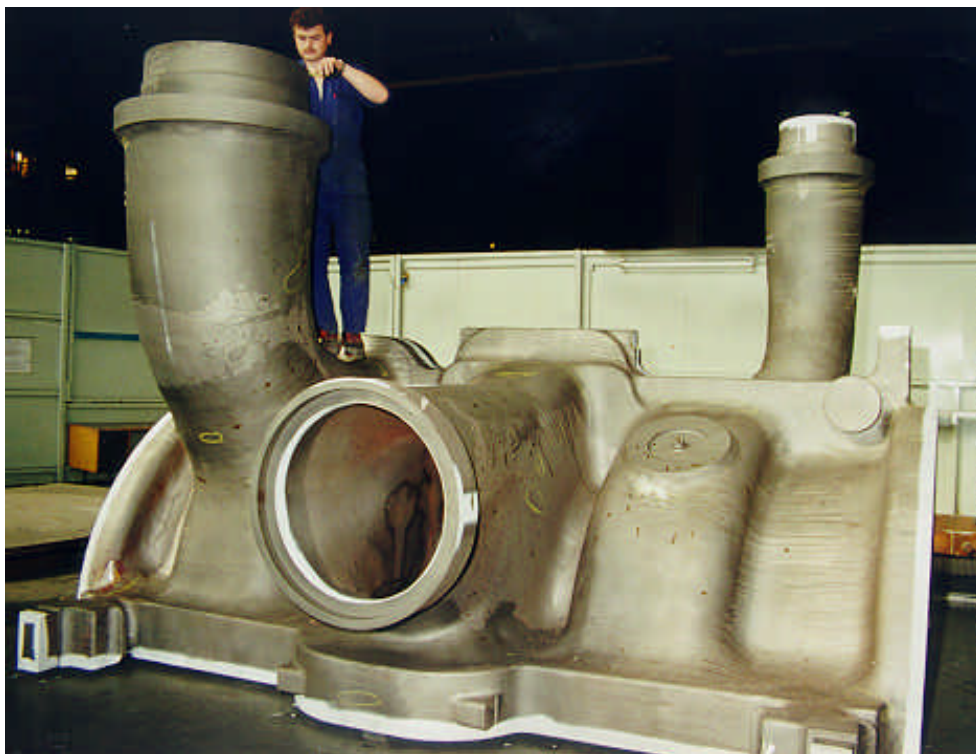
Abbildung 8: Projekt Schwarze Pumpe, MD Innengehäuse, 40 t mit angeschweißten, gegossenen Krümmern (G-X 12 CrMoWVNbN 10 1 1)
